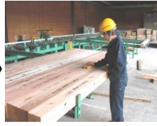
グレーディングマシン (ヤング係数の測定)
